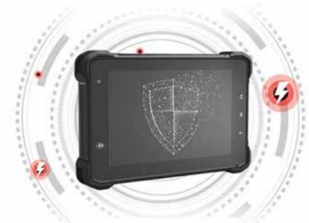
Protección acorde a los tests MIL-STD 810G contra vibraciones, golpes y caídas de hasta 1,5 metros gracias al refuerzo de TPU en las esquinas. Cumple con la especificación IP67 a prueba de polvo y de salpicaduras.
